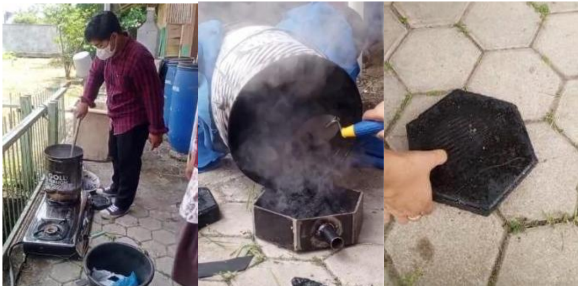
Gambar 3. Proses Uji Coba Komposisi Pembuatan Paving Block
