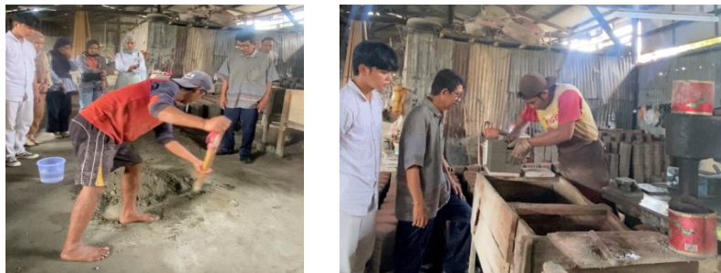
Gambar 3.3. Peragaan pembuatan paving block di PT Sinar Diamond
